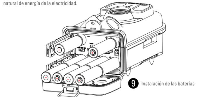
Después de abrir la tapa inferior de cámara, él fácilmente para encontrar el portapilas por desplegar el retén cerradura de Junta de la tapa, instale las pilas según la polaridad marcada en la placa de cubierta correctamente y, a continuación, bloquear el tablero de cubierta.
