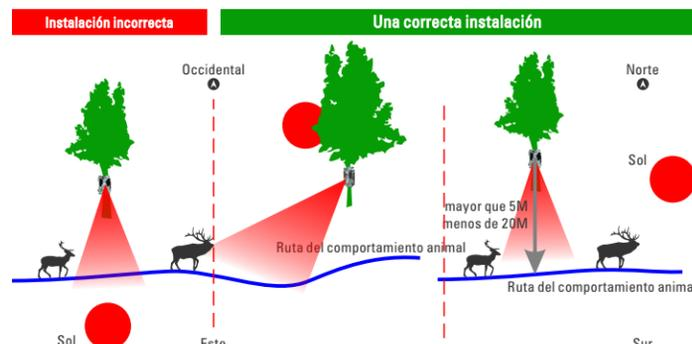
Use las correas para sujetar la cámara firmemente en el tronco más grueso; Ajuste el sensor de ángulo de tiro. Cuando fija, atención a la altura de instalación de tiro correspondiente destino de movimiento.
